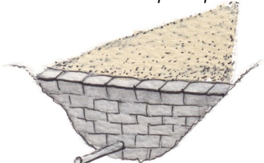
Barrage de sable
